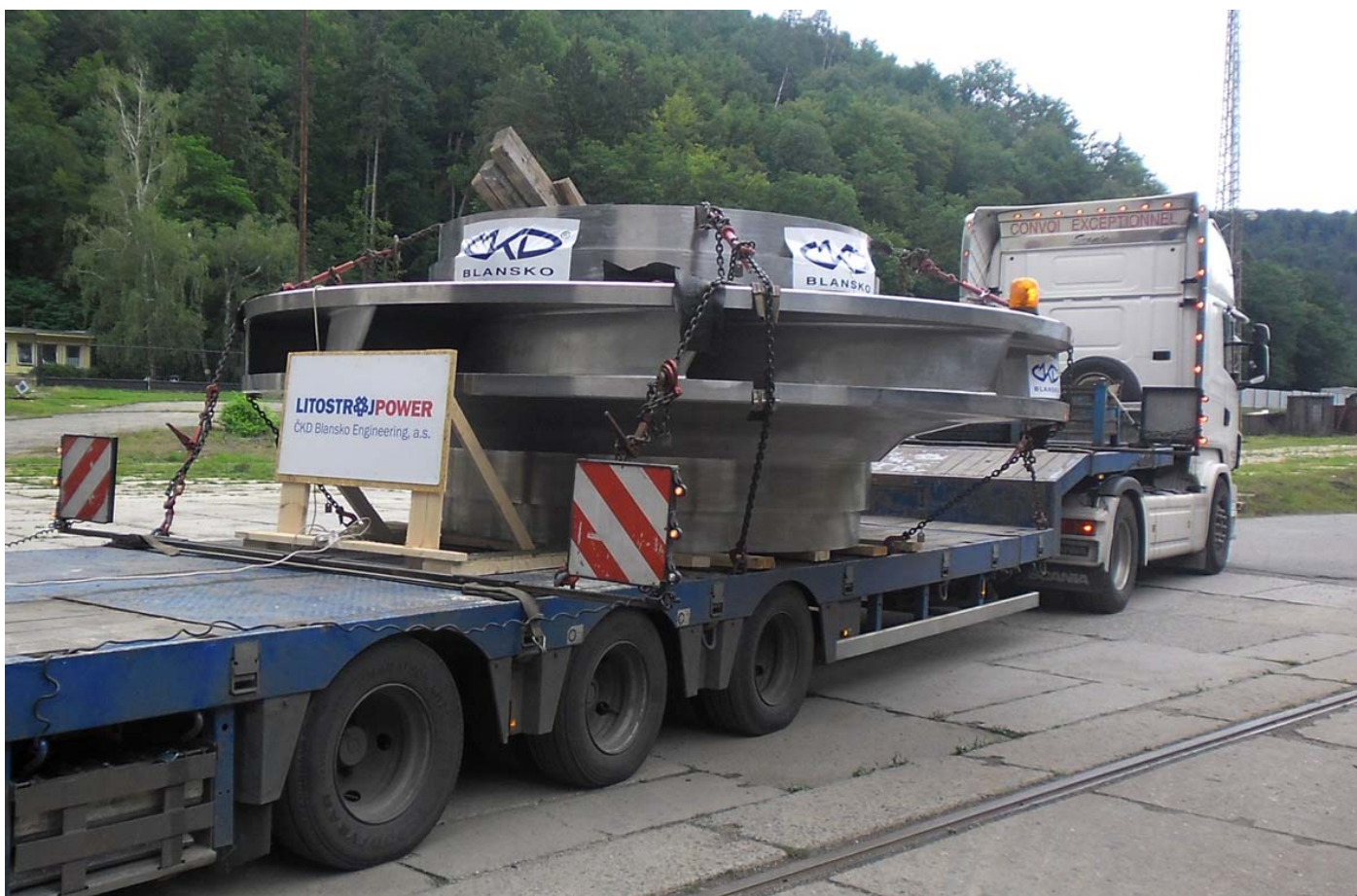
Expedice nového 9-ti lopátkového oběžného kola TG1 z výrobního závodu na elektrárnu Dlouhé Stráně
